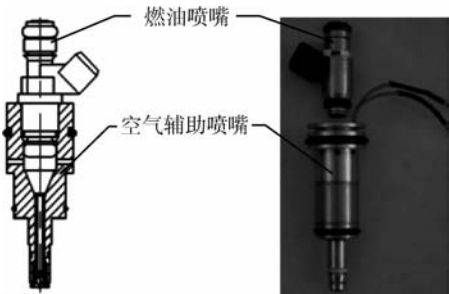
图 2 低压空气辅助直喷喷嘴
